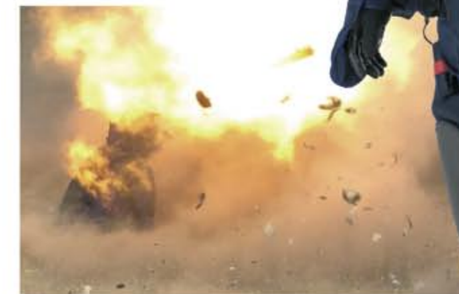
Hochgeschwindigkeitsaufnahme: EOD-Schutzanzug SPS-3 Sprengtest mit 0,66 kg Pentolite aus 60 cm Entfernung.
